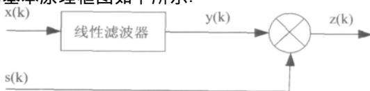
图11 球不变随机过程法原理框图
