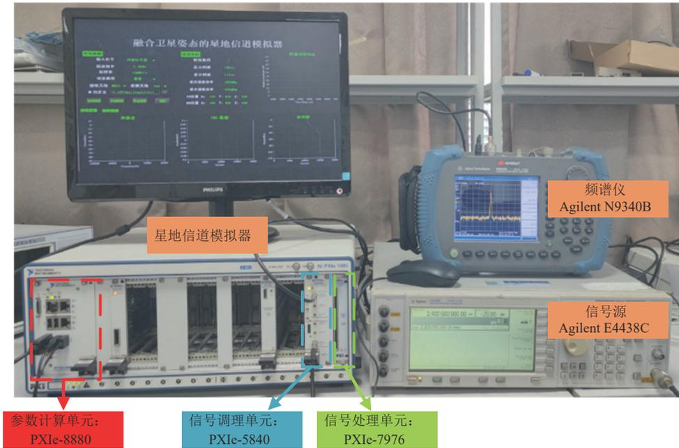
图6 星地信道模拟设备实物图
