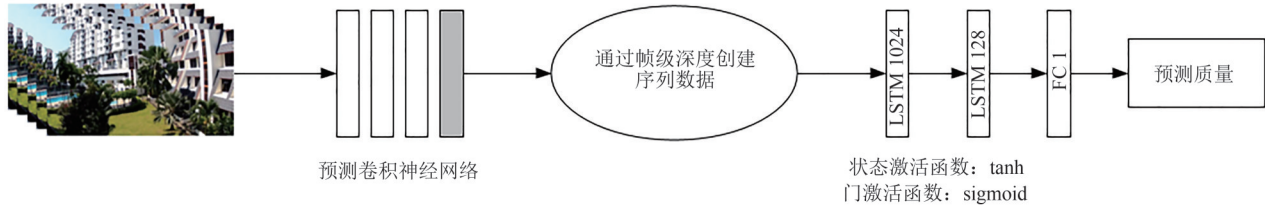
图10 CNN和LSTM算法框架 [64]
