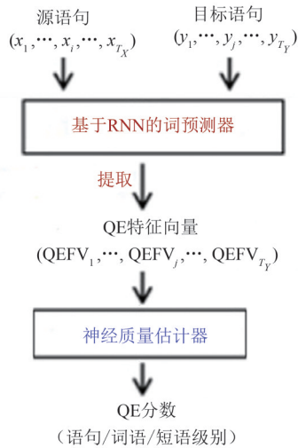
图 18 两级预测估计器结构 [114]
