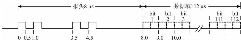
图 1 ADS-B 信号格式
